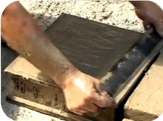
*Lissage et raclage de la surface de briques non fibrées*
