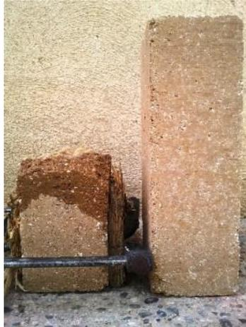
*Test d'immersion réalisé sur une brique compressée sans ciment (Le Village, Cavaillon, après à gauche, avant à droite)*
