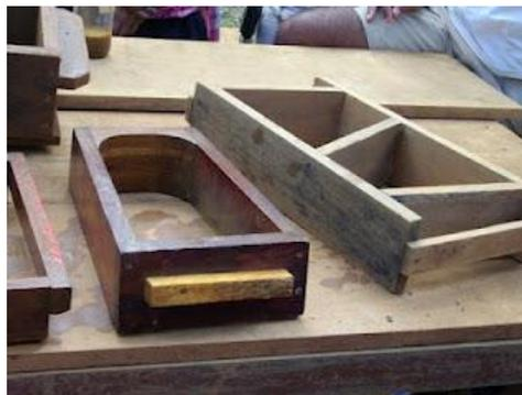
*Moules pour extrémité de mur arrondi et moules pour mur courbe*
