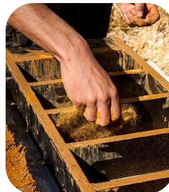
*Traces de sable sec sur le support (sable tamisé jeté au fond du moule, Le Village)*
