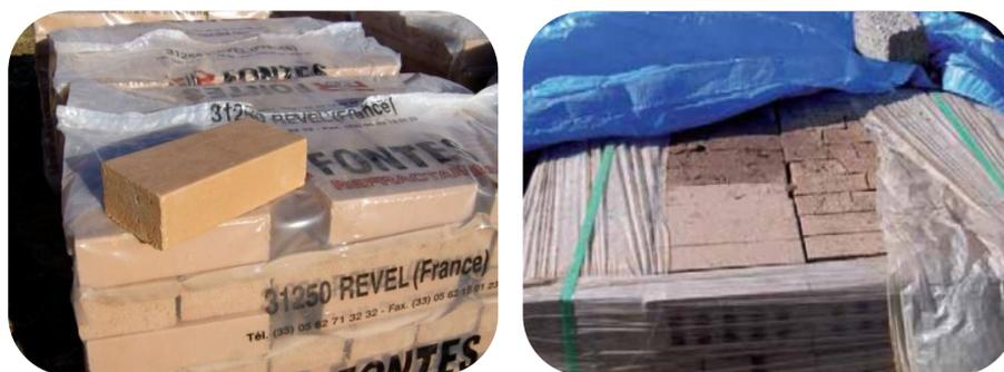
*Briques correctement stockées sous housse – briques mal stockées sous film cellophane*
