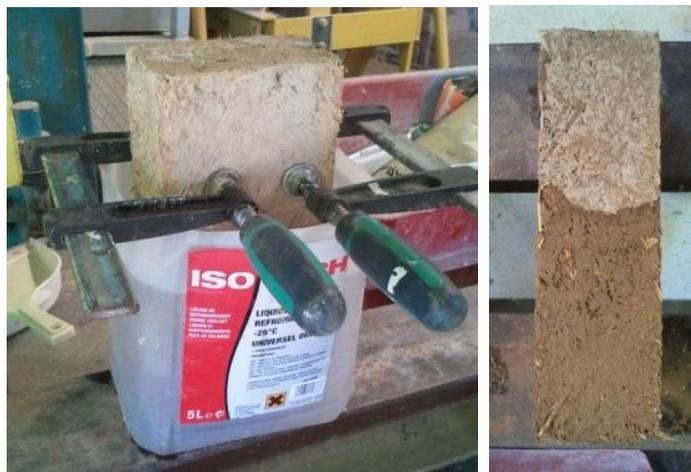
*Test d'immersion réalisé sur des adobes fibrées allégées (Le Village, Cavailon)*
