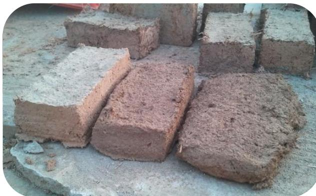
*Trois adobes fibrées, moulées à partir d'un mélange plastique un peu trop mouillé (à gauche) à un mélange de plus en plus visqueux*
