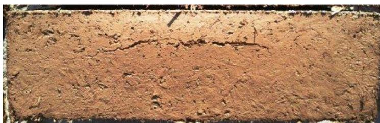
*Adobe fissurant (mélange trop mouillé, séchage rapide, sable fin)*
