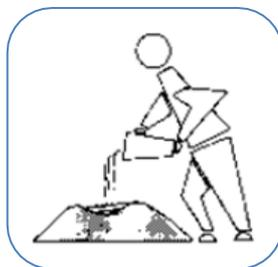
Le malaxage peut être fait à petite échelle avec les pieds (c'est amusant 5 minutes, mais on s'en lasse vite et on peut s'abîmer les pieds), mais peut aussi être plus ou moins mécanisé suivant la quantité d'adobes à produire. La présence de « gros grains » n'est pas souhaitable pour les machines qui malaxent le mélange, ça les fait s'user prématurément. De même, on s'abîme vite les mains avec les sables grossiers, les sables anguleux et la paille trop longue et rigide.
