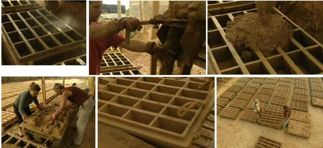
*Les adobes sont moulées sur des palettes (20 par palettes), disposées à mi-hauteur sur des chariots. Les chariots sont emmenés plusieurs à la fois jusqu'à l'aire de séchage, avant que les palettes ne soient déchargées à l'aide d'un chariot élévateur. Le transport se fait avec les briques dans les moules, et le démoulage se fait manuellement en soulevant les moules à 20 compartiments avec de simples cordes (2 personnes requises).*
