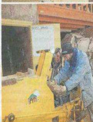
Des salariés en insertion fabriquent des briques de terre compressée. La terre a aussi été utilisée pour construire dix pavillons d'accueil en « pension de famille » (en haut à droite). © AFP
